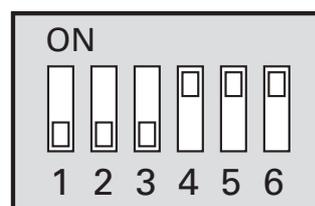
L'image présente le commutateur DIP (AA1-S2) en réglage d'usine
