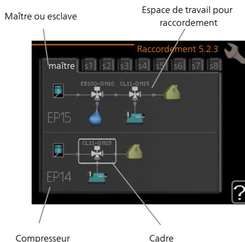
**Maître/esclave** : sélectionnez la pompe à chaleur pour laquelle le réglage du raccordement doit être effectué (s'il n'y a qu'une seule pompe à chaleur dans le système, seul le maître est affiché).
