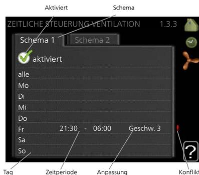
**Anpassung:** Hier wird die gewünschte Ventilator Drehzahl eingestellt.
