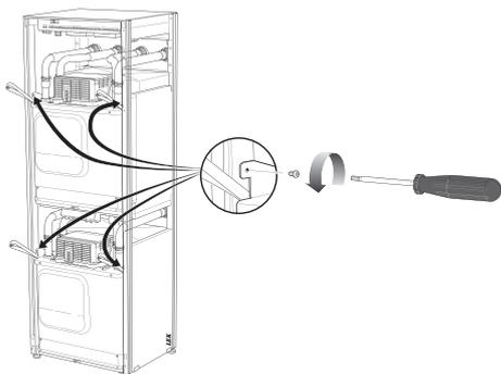
5. Ziehen Sie die Klemmen ab (vier für jedes Kältemodul) und trennen Sie die Rohre vorsichtig ab.
