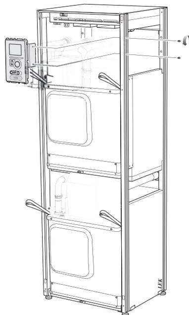
8. Ziehen Sie mithilfe der Hubösen am Modul vorsichtig das obere Kältemodul (EP15) heraus. Verwenden Sie dabei eine heb- und senkbare Abstellfläche.
