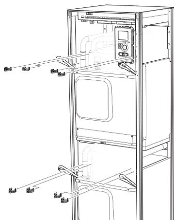
6. Lösen Sie den Anschluss an der Unterseite des Bedienfelds (diesen Schritt müssen Sie nur durchführen, wenn Sie das obere Kältemodul herausziehen wollen).
