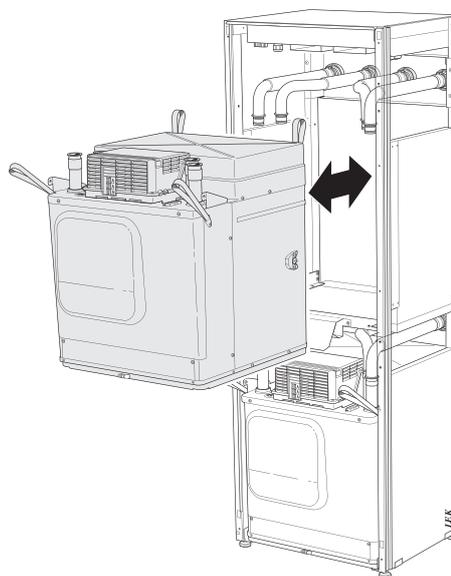
9. Ziehen Sie mithilfe der Hubösen am Modul vorsichtig das untere Kältemodul (EP14) heraus.
