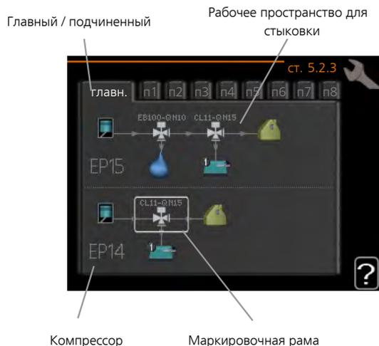
**Главный / подчиненный:** здесь выбирается тепловой насос, для которого должны быть выполнены настройки стыковки (если в системе только один тепловой насос, отображается только главный).
