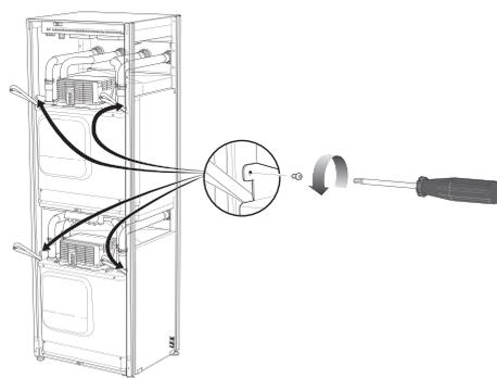
5. Снимите зажимы (четыре на каждый компрессорный модуль) и осторожно отсоедините трубы.
