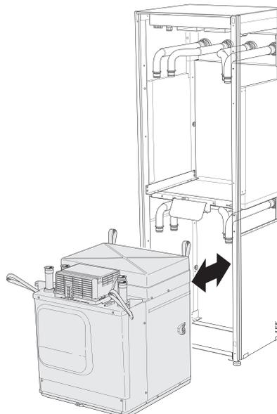
Если тепловой насос не закреплен на месте, необходимо сначала снять верхний модуль, а затем нижний.
