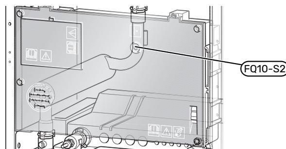
Der Sicherheitstemperaturbegrenzer (FQ10) unterbricht die Stromzufuhr für die elektrische Zusatzheizung, wenn die Temperatur 89 °C überschreitet. Der Sicherheitstemperaturbegrenzer wird manuell zurückgesetzt.
