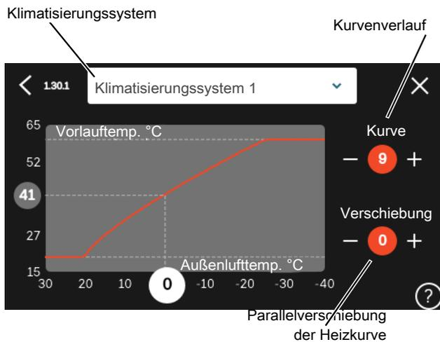
1. Wählen Sie das Klimatisierungssystem aus (wenn mehrere Systeme vorhanden sind), für das die Kurve geändert werden soll.
