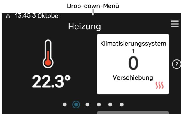
Das Drop-down-Menü zeigt den aktuellen Status von S1155PC, welche Teile in Betrieb sind und was S1155PC derzeit ausführt. Die derzeit in Betrieb befindlichen Funktionen werden mittels eines Rahmens markiert
