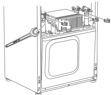
4. Lösen Sie die beiden Schrauben.
