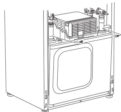
5. Lösen Sie die Kontakte (XF2), (XF11) und (XF22).
