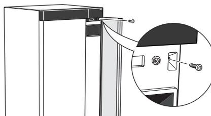
2. Ziehen Sie die obere Kante des Blechs zu sich, und heben Sie es schräg nach oben, um es aus dem Rahmen zu lösen.
