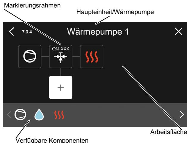
*Haupteinheit/Wärmepumpe:* Hier stellen Sie ein, für welche Wärmepumpe die Anschlusseinstellung vorgenommen werden soll (bei einer einzelnen Wärmepumpe im System wird nur die Haupteinheit angezeigt).
