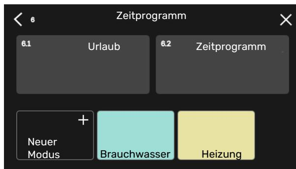
Wählen Sie die Einstellungen aus, die der Modus enthalten soll. Wischen Sie mit dem Finger nach links, damit Sie dem Modus einen Namen und eine Farbe zuordnen können, so dass er sich direkt von anderen Modi unterscheiden lässt.
