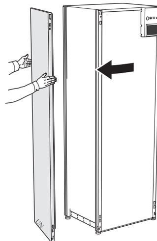
4. Die Montage erfolgt in umgekehrter Reihenfolge.
