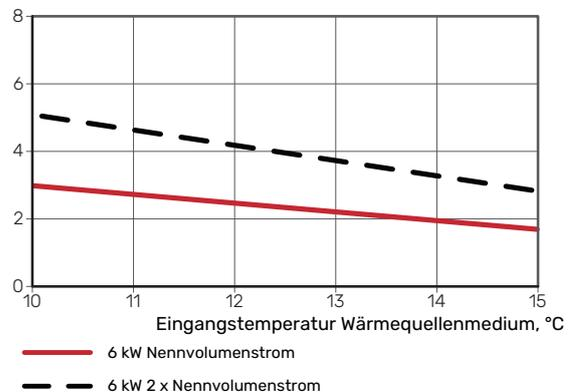
Passive Kühlung, 23 °C Rücklauftemperatur Nennvolumenstrom WQM/HM.
