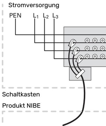
Verbinden Sie das Kabel mit Anschlussklemme AA2-X30:9-12, wobei X30:9 als gemeinsame Anschlussklemme für die drei Stromwandler dient.
