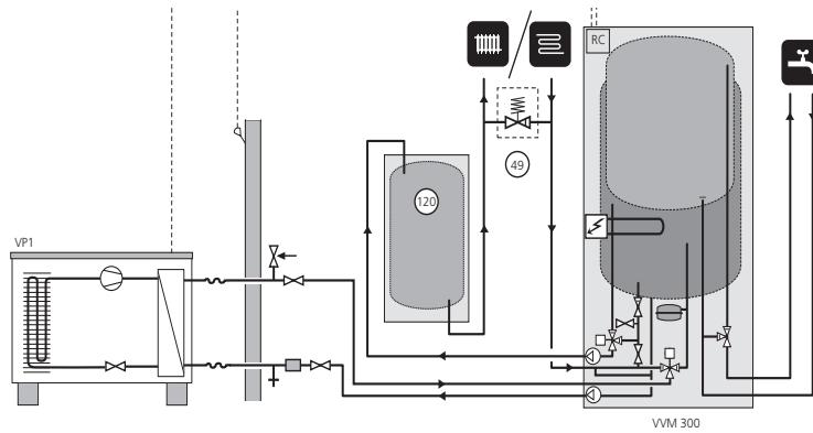
Als het systeemvolume in het verwarmingssysteem <20 l/kW is (vermogen warmtepomp bij 7/45 °C) en/of de stroom in het verwarmingssysteem ongecontroleerd wordt gesmoord, wordt als volume- en doorstroomverhoging een UKV-tank (120) geïnstalleerd. De niet-gebruikte aansluitingen worden afgedicht. Bij kans op potentiële 0-stroom moet een drukgeregelde overloopklep worden geïnstalleerd.
