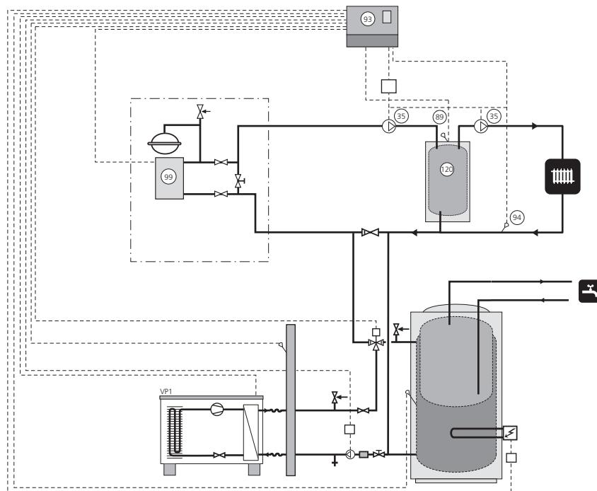
V případě, že objem systému v radiátorovém okruhu je nižší než 20 l/kW (výkon tepelného čerpadla při 7/45 °C) a/nebo není regulovalo tlumení průtoku v radiátorech, nádrž UKV se instaluje jako prostředek na zvýšení objemu a průtoku. Spojka T se musí umístit co nejblíže nádrži UKV.
