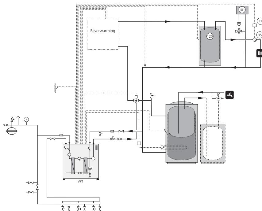
Voor grote vrijstaande huizen en panden met meerdere woningen, fabriekshallen e.d. met grote luchttoevoereenheden. De accumulatortank wordt gebruikt als buffer voor de luchttoevoereenhed. De T-koppeling moet zo dicht mogelijk bij de UKV-tank worden geplaatst
