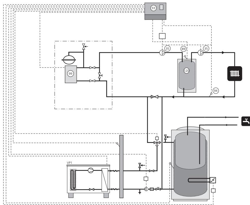
I de fall då systemvolymen i radiatorkretsen är under 20 l/kW (värmepumpseffekt vid 7/45 °C) och/eller radiatorflödet stryps okontrollerat installeras en UKV-tank som volym- och flödesförhöjare. T-rörskopplingen skall placeras så nära UKV-tanken som möjligt.
