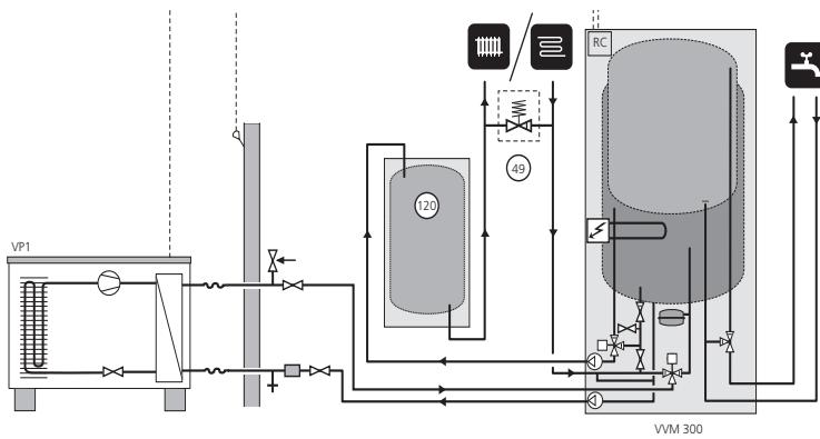
Wenn das Systemvolumen im Heizungssystem unter  $20 \text{ l/kW}$  (Wärmepumpenleistung bei  $7/45^\circ\text{C}$ ) liegt und/oder das Heizungssystem unkontrolliert gedrosselt wird, muss ein UKV-Speicher (120) zur Volumen- und Flussvergrößerung installiert werden. Nicht benötigte Anschlüsse müssen mit Stopfen verschlossen werden. Beim Risiko eines potentiellen Nullvolumenstroms muss ein druckgesteuertes Überströmventil installiert werden.
