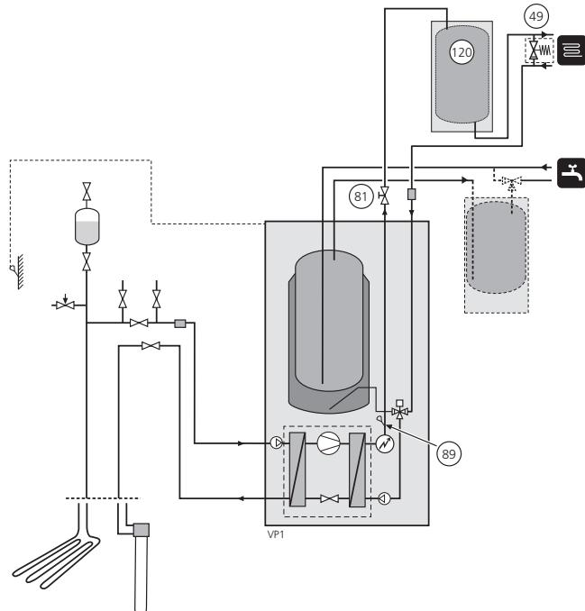
Toto zapojení se používá v případě nedostatečného objemu systému nebo za účelem omezení tepelných špiček v topném systému. Nádrž UKV se instaluje za účelem vyloučení tepelných špiček v topném systému. Zvolte diagonální připojení (např. vlevo nahoře a vpravo dolů). Uzavřete všechny připojky, které se nepoužívají. Pokud hrozí nebezpečí možného nulového průtoku, musí se nainstalovat automatický přepouštěcí ventil.
