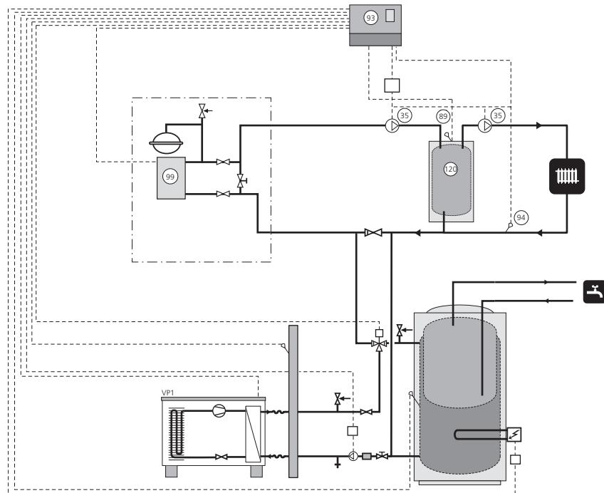
Jos patteripiirin tilavuus on alle 20 l/kW (lämpöpumpun teho lämpötilassa 7/45 °C) ja/tai patteripiirin virtausta kuristeaan hallitsemattomasti, asennetaan UKV-säiliö tilavuuden ja virtauksen suurentamiseksi. Paineohjattua ylivirtausventtiiliä voidaan käyttää mahdollisella 0-virtauksella.
