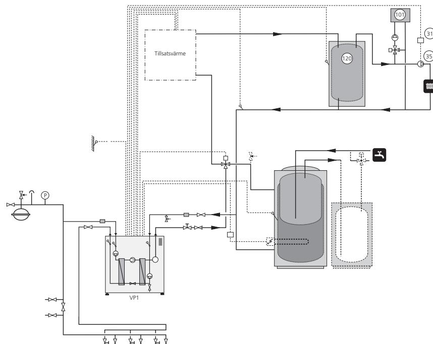
För större villor samt flerbostadshus, industrihallar eller liknande med stora tillluftsbatterier. Ackumulatortanken används som buffert för tillluftsbatteriet. T-rörskopplingen skall placeras så nära UKV-tanken som möjligt.
