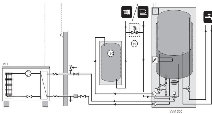
Jos lämmitysjärjestelmän järjestelmätilavuus on alle 20 l/kW (lämpöpumpun teho 7/45C) ja/tai lämmitysjärjestelmän virtausta kuristetaan hallitsemattomasti, asennetaan UKV-varaaja (120) tilavuuden ja virtauksen suurentamiseksi. Käyttämättömät liitännät tulpataan. Paineohjattu ohivirtausventtiili pitää asentaa, jos on olemassa 0-virauksen riski.
