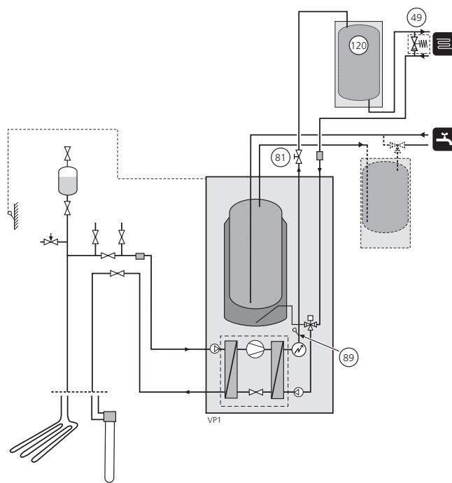
Denna dockning används när systemvolymen inte är tillräcklig eller för att reducera värmeknäppningar i värmesystemet. För att reducera värmeknäppningar i värmesystemet installeras en UKV-tank. Välj diagonala anslutningar (t.ex. vänster upp och höger ned). De anslutningar som inte används pluggas. Tryckstyrda överströmningsventil ska installeras för användning vid potentiellt 0-flöde.
