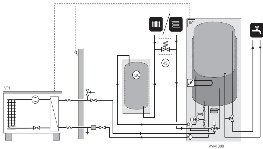
I de fall då systemvolymen i radiatorkretsen är under 20 l/kW (värmepumpseffekt vid 7/45 °C) och/eller radiatorflödet stryps okontrollerat installeras en UKV-tank som volymförhöjare. De anslutningar som inte används pluggas. Tryckstyrda överströmningsventil ska installeras för användning vid potentiellt 0-flöde.
