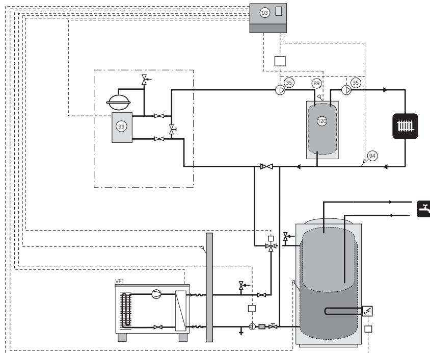
In gevallen waarbij het systeemvolume in het radiatorcircuit onder 20 l/kW ligt (warmtepompvermogen bij 7/45 °C) en/ of de radiatorstroom ongecontroleerd wordt gesmoord, wordt een UKV-tank geïnstalleerd als volume- en doorstroomvergroter. De T-koppeling moet zo dicht mogelijk bij de UKV-tank worden geplaatst.
