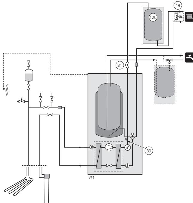
Tätä liitintää käytetään järjestelmän tilavuuden suurentamiseen tai lämmitysjärjestelmän lämpönaksahotelujen vähentämiseen. Valitse vinottain vastakkaiset liitännät (esim. vasemmalla ylhäällä ja oikealla alhaalla). Käyttämättömät liitännät tulpataan. Paineohjattu ohivirtausventtiili pitää asentaa, jos on olemassa 0-virauksen riski.
