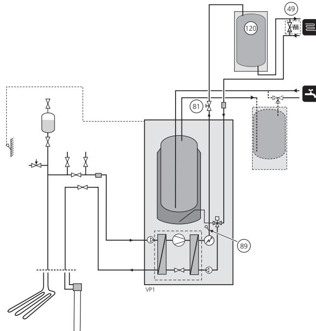
Deze koppeling wordt gebruikt als het systeemvolume niet voldoende is of om tikken in het verwarmingssysteem te voorkomen. Kies voor diagonale aansluitingen (bijv. linksboven en rechtsonder). De niet-gebruikte aansluitingen worden afgedicht. Bij kans op potentiële 0-stroom moet een drukgeregelde overloopklep worden geïnstalleerd.
