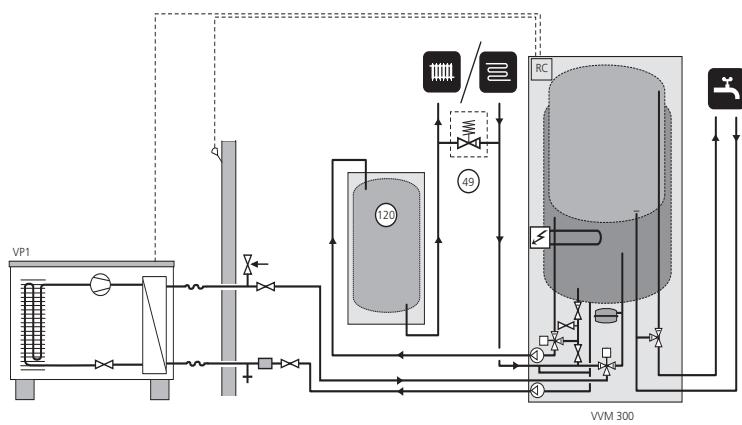
V případě, že objem systému v topném systému je nižší než 20 l/kW (výkon tepelného čerpadla při 7/45°C) a/nebo není regulovalo tlumení průtoku, nádrž UKV (120) se instaluje jako prostředek na zvýšení objemu a průtoku. Uzavřete všechny připojky, které se nepoužívají. Pokud hrozí nebezpečí možného nulového průtoku, musí se nainstalovat automatický přepouštěcí ventil.
