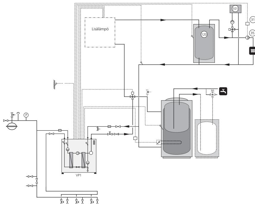
Suurempiin omakotitaloihin, kerrostaloihin, teollisuushalleihin tai vastaaviin, joissa on suuret tuloilmapatterit. Varaajasäiliöt käytetään tuloilmapatterin puskurisäiliönä. Paineohjattua ylivirtausventtiiliä voidaan käyttää mahdollisella 0-virtauksella.
