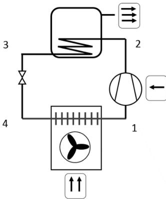
Figure 1 - Principe de la pompe à chaleur
