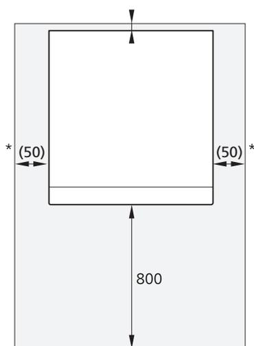
\* Une installation normale requiert 300 – 400 mm (pour tous les côtés) pour le raccordement d'équipements, tels que la cuve de niveau, les vannes ou tout équipement électrique.
