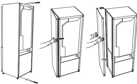
Les caches latéraux peuvent être retirés pour faciliter l'installation.
