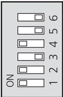
La imagen muestra el interruptor DIP (AA1-SF1) con el ajuste de fábrica para 3x230V, es decir 6 kW.
