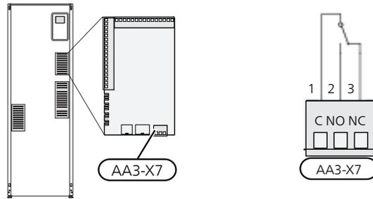
La ilustración muestra el relé en la posición de alarma. El relé está en la posición de alarma cuando el interruptor (SF1) está en la posición "⏻" o "⚠".
