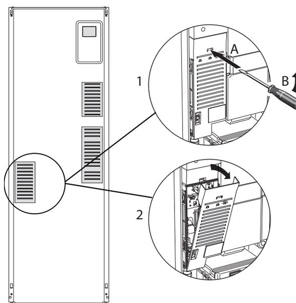
1. Inserte el destornillador (A) y empuje con cuidado el enganche hacia abajo (B).
