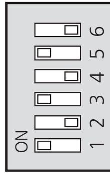
La imagen muestra el interruptor DIP (AA1-SF1) con el ajuste de fábrica para 1x230V, es decir 6 kW.
