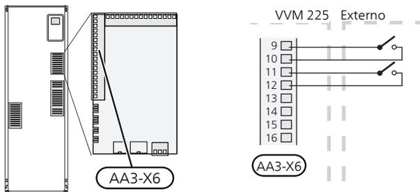
El ejemplo anterior utiliza las entradas AUX1 (X6:9-10) y AUX2 (X6:11-12) de la placa de entradas (AA3).
