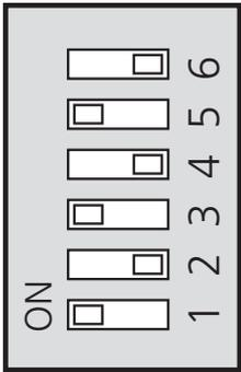
La imagen muestra el interruptor DIP (AA1-SF1) con el ajuste de fábrica para 3x400V, es decir 6 kW.
