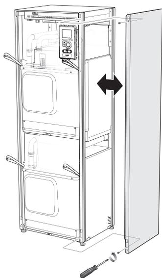
Les caches latéraux peuvent être retirés pour faciliter l'installation.
