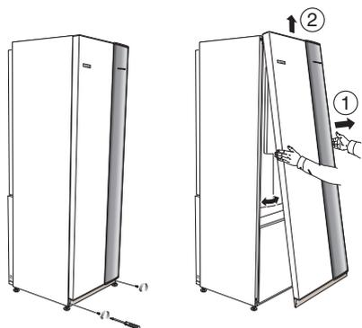
1. Retirez les vis du bord inférieur du panneau avant.
