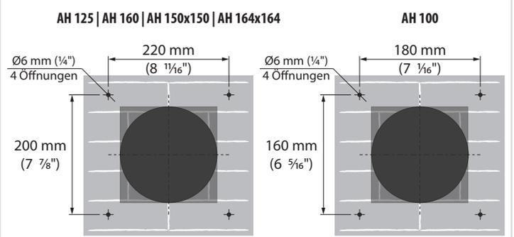
3. Die mitgelieferten Dübel (6x40) in die Löcher einsetzen. Die Lüftungshaube auseinanderbauen, um Zugang zu den Befestigungslöchern zu ermöglichen. Die Abdeckung der Lüftungshaube entfernen.
