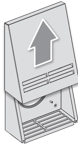
4. Die Rückseite der Lüftungshaube mit den mitgelieferten Schrauben (4x40) an der Wand befestigen.
