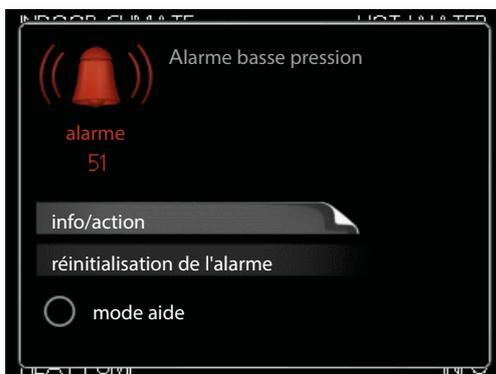
Si une alarme se déclenche et que le voyant d'état devient rouge, cela signifie qu'un dysfonctionnement que ni la pompe à chaleur, ni le module de commande ne peuvent résoudre. Pour afficher le type d'alarme et réinitialiser l'alarme, tournez le bouton de commande et appuyez sur le bouton OK. Vous pouvez également régler l'installation sur le mode aide.
