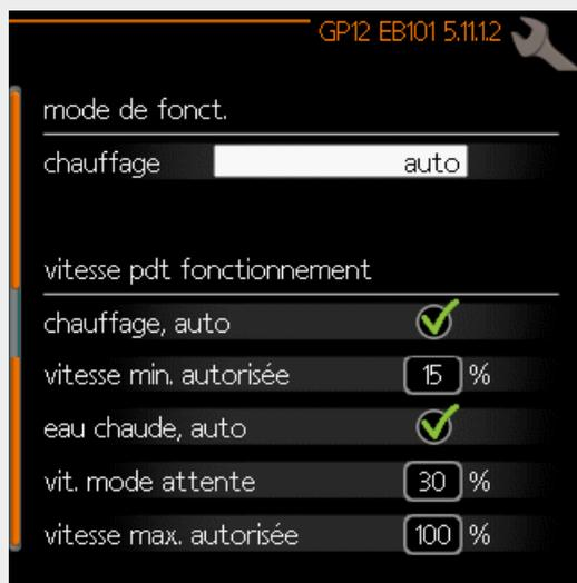
Ce menu vous permet de définir la vitesse de fonctionnement de la pompe de circulation GP10 pour le mode de fonctionnement actuel. En mode « auto », la vitesse de la pompe de charge s'ajuste automatiquement pour garantir un fonctionnement optimal.
