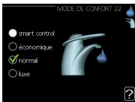
**Commande intelligente** : ce menu vous permet d'activer la fonction de commande intelligente. La commande intelligente évalue la consommation d'eau chaude de la semaine passée et ajuste en conséquence la température dans le ballon d'eau chaude pour la semaine à venir, pour une consommation d'énergie minimum.
