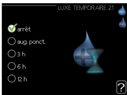
La fonction est immédiatement activée lorsqu'une période est sélectionnée et confirmée à l'aide du bouton OK. Le temps restant pour le réglage sélectionné s'affiche sur la droite. A la fin de la période, le régulateur revient au mode défini dans le menu 2.2.
