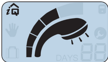
Fig. 9 Beschikbaar warmwaterniveau in de tank in de stand 'SMART'
