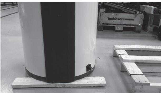
6. Das Produkt befindet sich nun auf dem Boden, mit den 2 Stück Holz darunter.
