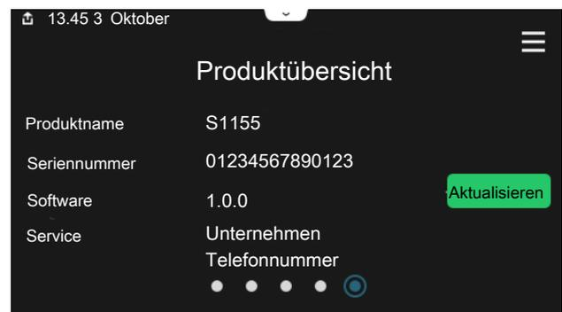
Hier finden Sie Angaben wie die Produktbezeichnung, die Seriennummer des Produkts, die Version der Software und den Service. Eventuelle Software kann hier heruntergeladen werden (sofern S1155 mit myUplink verbunden ist).
