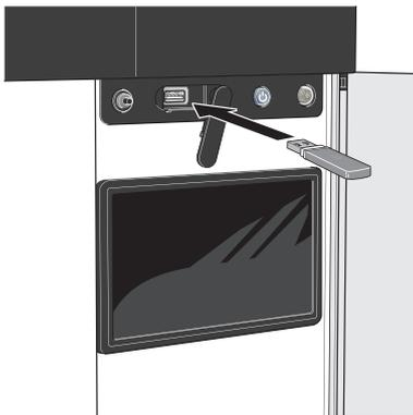
Das Bedienfeld verfügt über USB-Anschlüsse, die zum Aktualisieren der Software und zum Speichern protokollierter Informationen in S1155 genutzt werden können.
