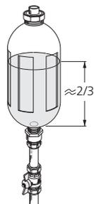
Pour augmenter la pression du système, fermez la soupape du circuit sortant principal lorsque la pompe à eau glycolée ((GP2)) est activée et que la cuve de niveau ((CM2)) est ouverte, de sorte que le liquide s'en échappe.
