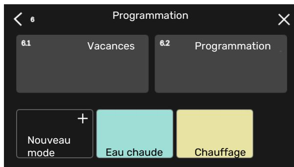
Sélectionnez les réglages à inclure dans le mode. Faites glisser votre doigt vers la gauche pour sélectionner le nom et la couleur du mode afin de le distinguer des autres modes.
