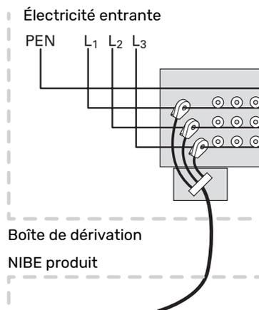
Raccordez le câble au bornier AA2-X30:9-12, où X30:9 est le bornier commun pour les trois capteurs d'intensité.
