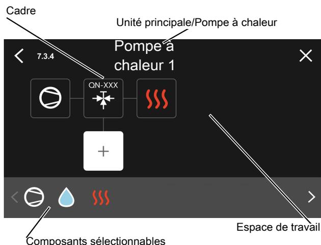
**Unité principale/Pompe à chaleur :** Sélectionnez ici la pompe à chaleur pour laquelle le réglage du raccordement doit être effectué (s'il n'y a qu'une seule pompe à chaleur dans le système, seule l'unité principale est affichée).
