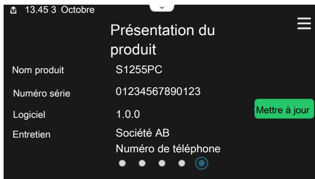
Vous pouvez rechercher ici des informations sur le nom du produit, le numéro de série du produit, la version du logiciel et l'entretien. Les nouvelles versions du logiciel peuvent être téléchargées ici (si S1255PC est connecté à myUplink).
