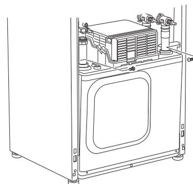
5. Débranchez les raccords (XF2), (XF11) et (XF22).
