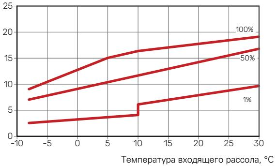
**Температура подаваемого теплоносителя, теплоноситель 50° С**
