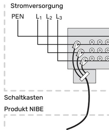
Verbinden Sie das Kabel mit Anschlussklemme AA2-X30:9-12, wobei X30:9 als gemeinsame Anschlussklemme für die drei Stromwandler dient.
