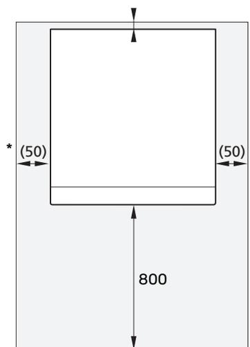
\* Eine normale Installation erfordert 300–400 mm (beliebige Seite) zur Anschlussausrüstung, z. B. Niveaugefäß, Ventile und elektrische Ausrüstung.
