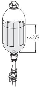
Falls der Druck im System erhöht werden muss, schließen Sie das Ventil an der Hauptaustrittsleitung, wenn die Wärmequellenpumpe (GP2) in Betrieb und das Niveaugefäß (CM2) geöffnet ist, wodurch Flüssigkeit vom Gefäß abgesaugt werden kann.
