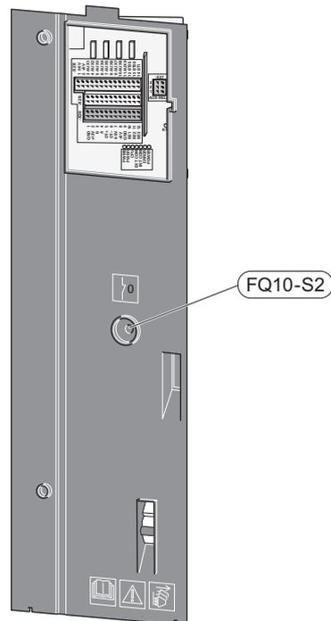
Der Sicherheitstemperaturbegrenzer (FQ10) unterbricht die Stromzufuhr für die elektrische Zusatzheizung, wenn die Temperatur 89 °C überschreitet. Der Sicherheitstemperaturbegrenzer wird manuell zurückgesetzt.
