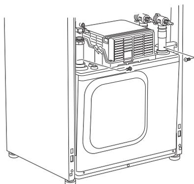
5. Lösen Sie die Kontakte (XF2), (XF11) und (XF22).
